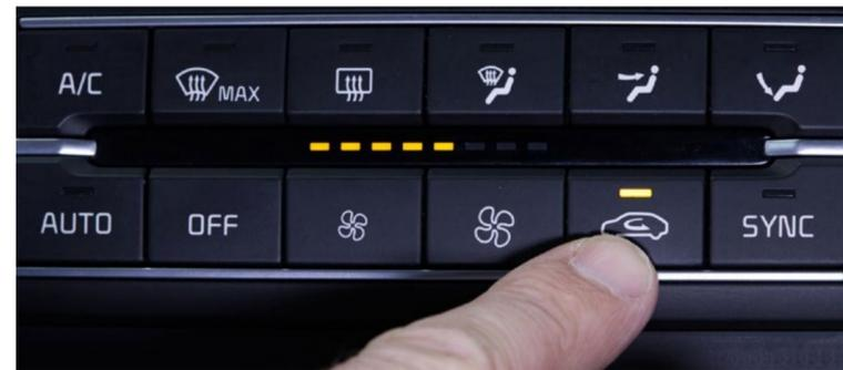
[Fig. 11] Boutons mécaniques fixes organisés en lignes, avec des pictogrammes minimalistes blancs offrant une lisibilité claire de leur fonction.
