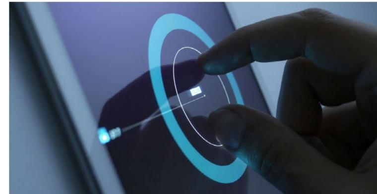
[Fig. 33] Prototype interactif de l'interface utilisateur, plaçant automatiquement les commandes sous les doigts au toucher. Glisser pour ajuster un paramètre.
