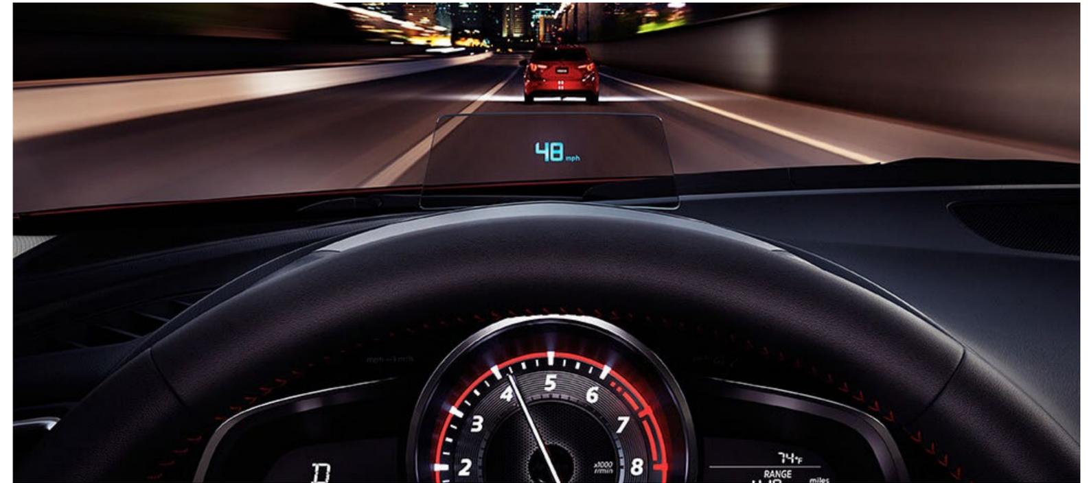
[Fig. 18] Affichage tête haute (HUD) de la Mazda 3. Les informations de conduite sont projetées sur une lame fumée.
