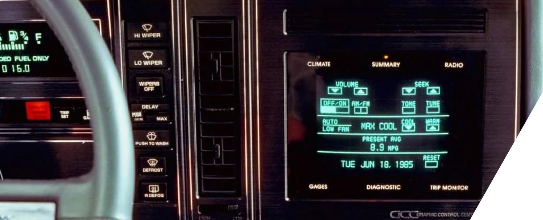
[Fig. 1] Tableau de bord de la Buick Riviera 1986 avec l'écran tactile «Graphic Control Center».
