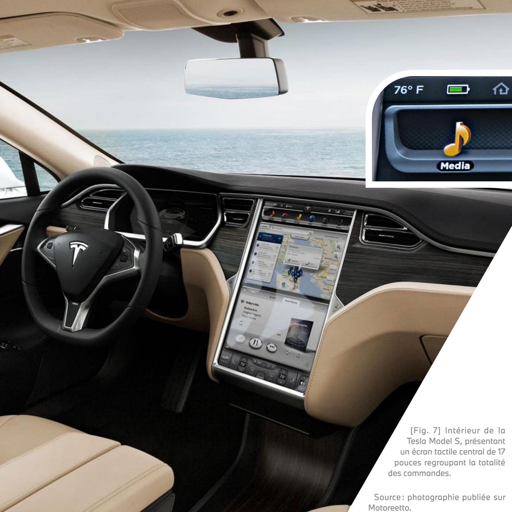
[Fig. 7] Intérieur de la Tesla Model S, présentant un écran tactile central de 17 pouces regroupant la totalité des commandes.
