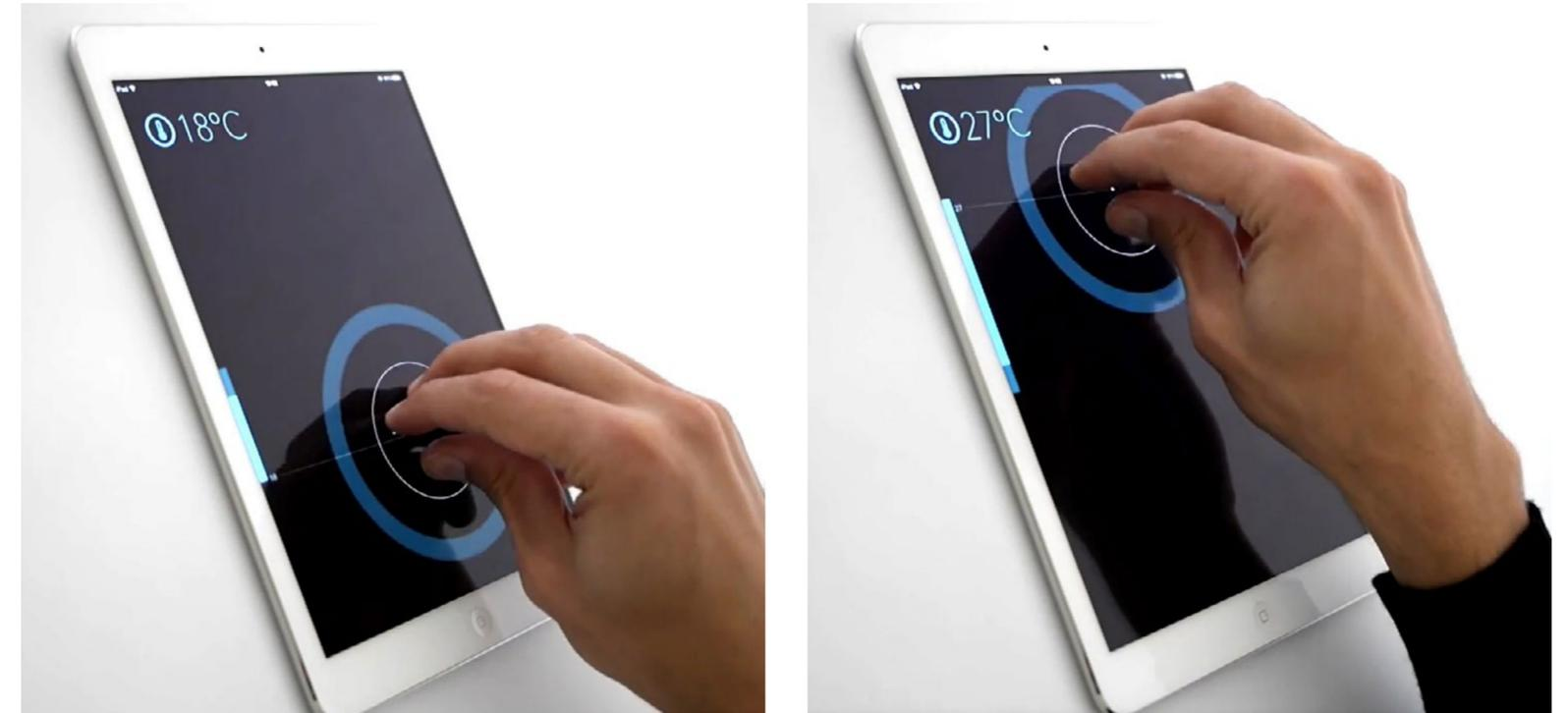
[Fig. 19 & Fig. 20] Prototype montrant le changement de la fonction température en faisant glisser cinq doigts de bas en haut.
